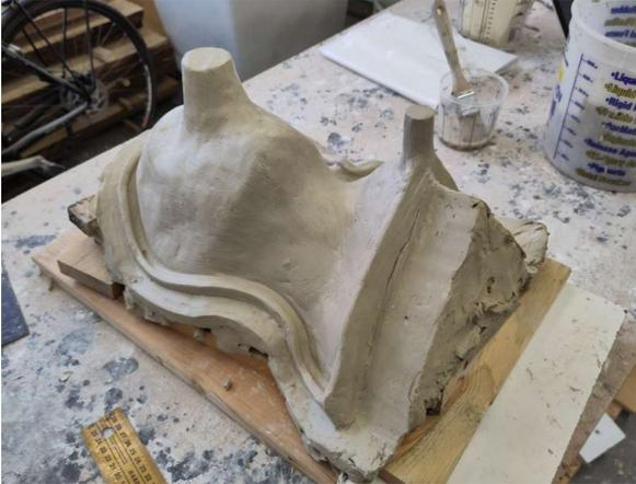
3.3. Forme Tonübergänge an schwer entlüftbaren Stellen, wie etwa am Kinn und an der verzahnten Tonkante, um sicherzustellen, dass keine Luftblasen eingeschlossen werden. So kann die Luft besser entweichen, und die Silikonform wird ohne Fehler gegossen.
