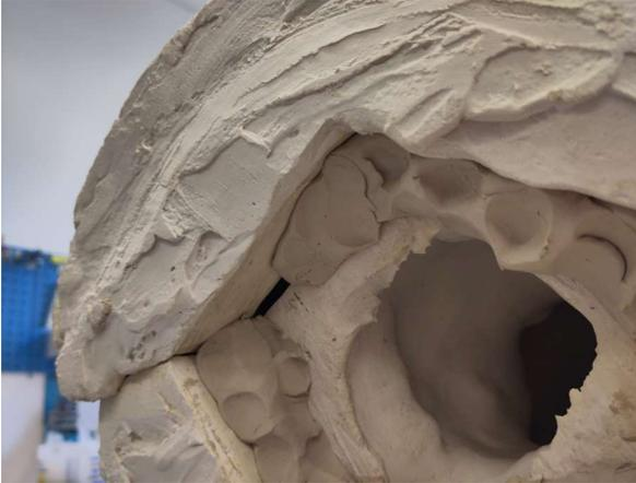
8.6. Stopfe die Einguss- und Entlüftungskanäle mit Papier aus, damit während des Modellierens der Schornsteine kein Ton hineinfällt.
