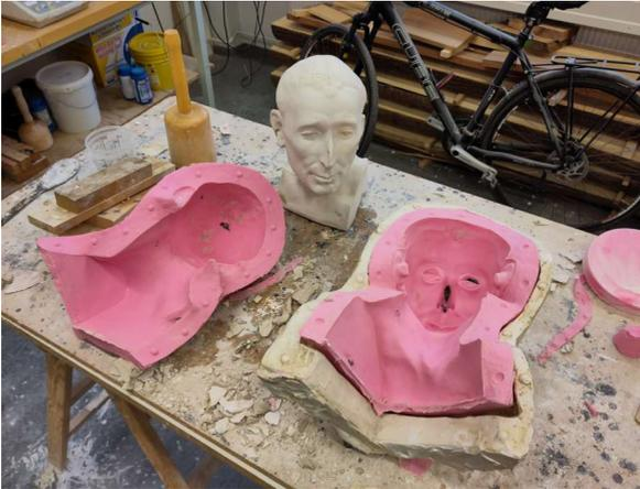
9.9. Versiegle die Gipsschalen, indem du sie mit Schellack einpinselst. Dadurch werden die Poren im Gips geschlossen, was das Eindringen von Flüssigkeiten verhindert. Zudem erleichtert die Versiegelung das spätere Trennen der Silikonformen von den Gipsschalen.
