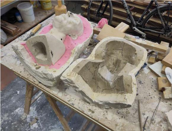
9.6. Entferne mit einem Skalpell Silikon, welches zwischen die beiden Gipsschalen geflossen ist.
