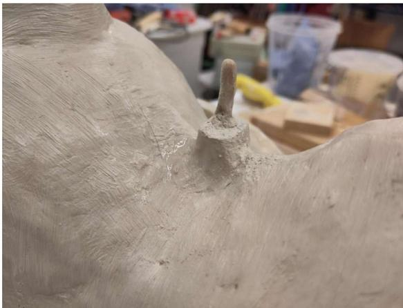
3.5. Modelliere Formschlösser mit einem kugelförmigen Modellierwerkzeug und platziere diese im Abstand von ca. 10 cm um das Objekt herum. Diese Vertiefungen sorgen später dafür, dass die beiden Hälften der Gipschalen präzise aufeinandersitzen und sich nicht verschieben.
