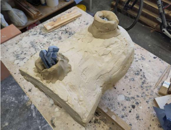
8.8. Trage eine großzügige Schicht Tonschlick entlang des Risses zwischen den Gipsschalen auf, damit sich der nachfolgende Gips nicht mit den Schalen verbindet.
