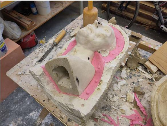
9.7. Wiederhole die Schritte 7.3 bis 9.4 für die Herstellung der zweiten Silikonform. Arbeitsanweisungen, die die Tonoberfläche betreffen, wie das Modellieren von Schlössern oder das Glätten der Tonoberfläche, entfallen, da der Ton inzwischen durch Silikon ersetzt wurde.
