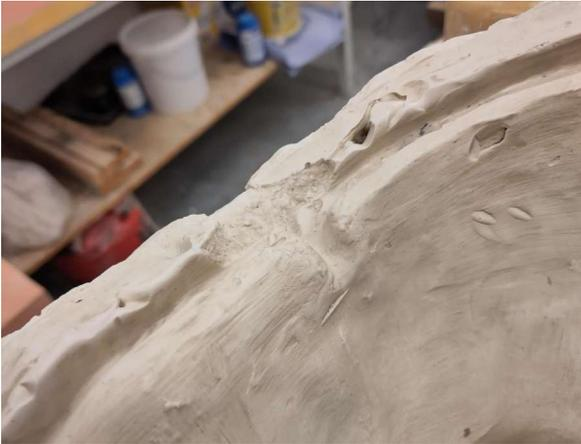
7.3. Reinige die zweite Gipsform sorgfältig mit Wasser. Bewahre den verwendeten Ton in einem Eimer auf, um das spätere Silikonvolumen bestimmen zu können.
