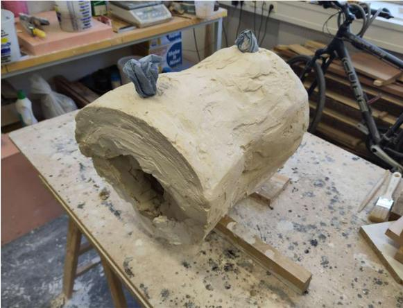
8.7. Verlängere die Einguss- und Entlüftungskanäle mit Schornsteinen aus Ton, damit das Silikon später sauber ein- und die Luft entweichen kann.
