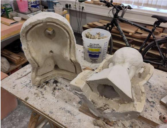
7.2. Sind beim Öffnen der Form versehentlich Teile der Gipsschalung abgefallen, ersetze diese Stellen nicht mit neuem Gips, sondern maximal mit Ton. So stellst du sicher, dass die beiden Gipsformen später perfekt aufeinanderpassen. Falls Silikon in die weggefallenen Stellen läuft, kann es später einfach mit einem Skalpell oder scharfen Messer entfernt werden.
