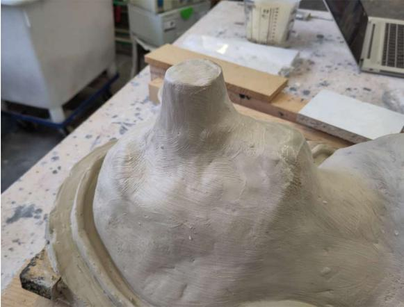
3.2. Erstelle Entlüftungskanäle aus Ton an den Stellen, an denen die beim Silikoneinguss verdrängte Luft entweichen können soll, zum Beispiel an der Brust. Diese Kanäle sollten einen Durchmesser von ca. 2 cm haben und ebenso hoch wie der Eingusskanal sein.
