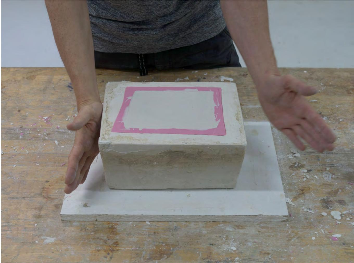
Mit der einen Hand stoßen wir leicht gegen die Stützform, während die andere Hand die Stützform in Position hält. So werden eingeschlossene Luftbläschen an die Oberfläche befördert und platzen.
