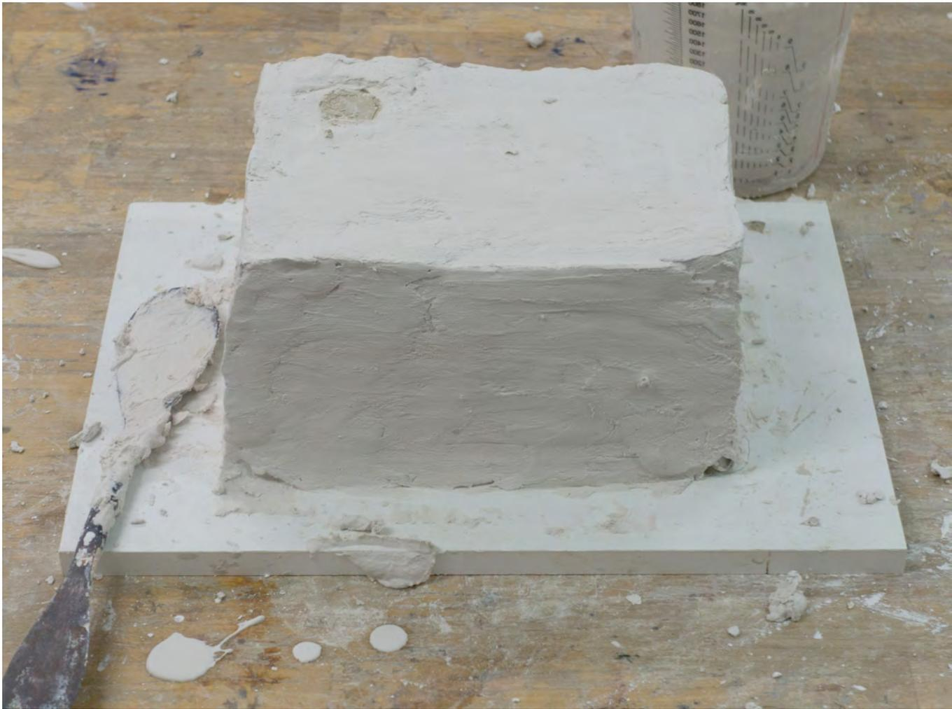
Am Ende lugt nur noch eine kleine kreisrunde Tonfläche aus dem Gips hervor. Das ist die oberste Schicht der Füllöffnung. Hier werden wir, sobald der Gips hart geworden ist und wir den Ton entfernt haben, Silikon eingießen.
