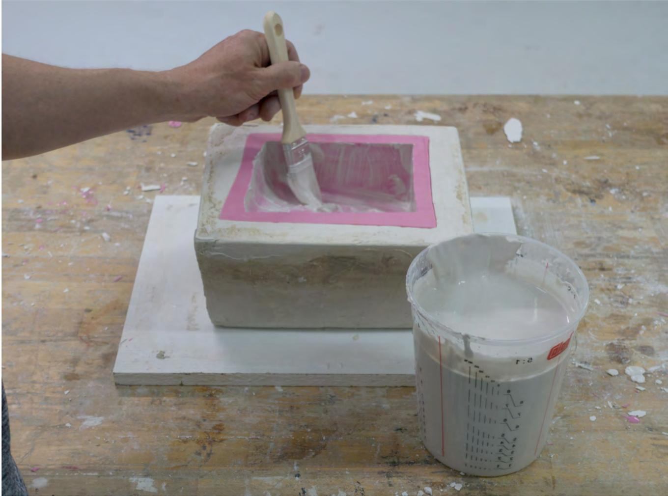
Eine erste Schicht Gips pinseln wir auf die Mantelform. Das machen wir, damit die Oberfläche der Kopie frei von möglichen Luftblasen ist. Reinigen wir den Pinsel zeitnah, können wir den Pinsel mehrere Male verwenden. Ansonsten würde der Gips hart werden und der Pinsel unbrauchbar.
