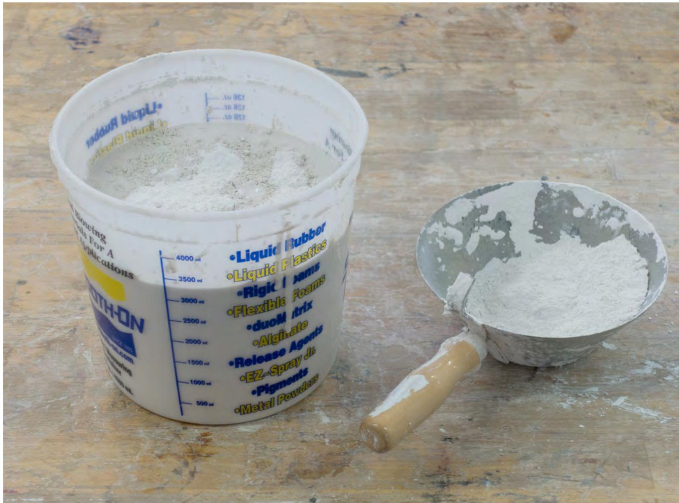
In das Wasser streuen wir Gips, bis der Gips die Wasseroberfläche erreicht und einen kleinen Hügel bildet. Den Gips lassen wir im Wasser einige Minuten lang sumpfen. Nun nehmen wir einen Rührbesen und drehen ihn langsam durch das Gemisch.
