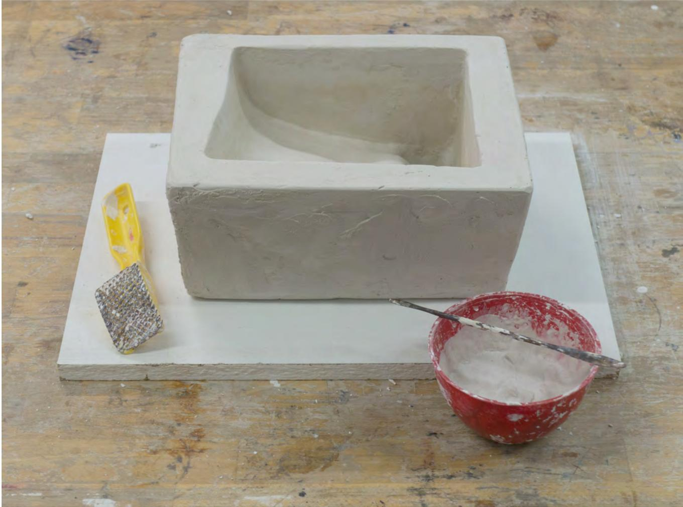
Die Stützform wird mit einer Raspel überarbeitet. Kleine beim Gießen entstandene Löcher entweder mit Ton oder mit neu angerührtem Gips gefüllt.
