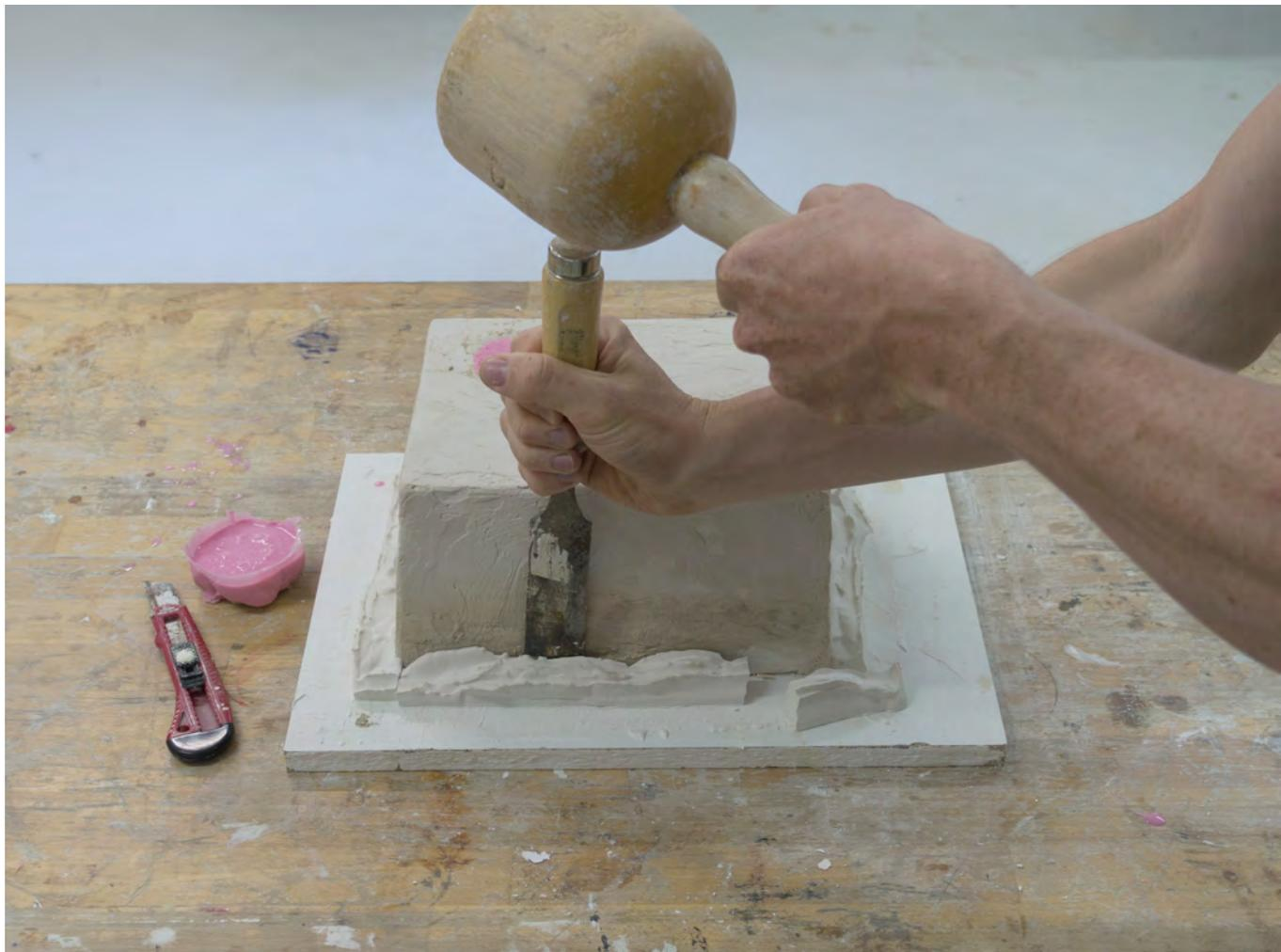
Nachdem das Silikon ausgehärtet ist, wird die Gipsmauer um die Stützform herum mit Klüpfel und Stemmeisen abgeschlagen. Weiterhin schneiden wir mit einem Cutter das aus der Füllöffnung quellende Silikon ab.
