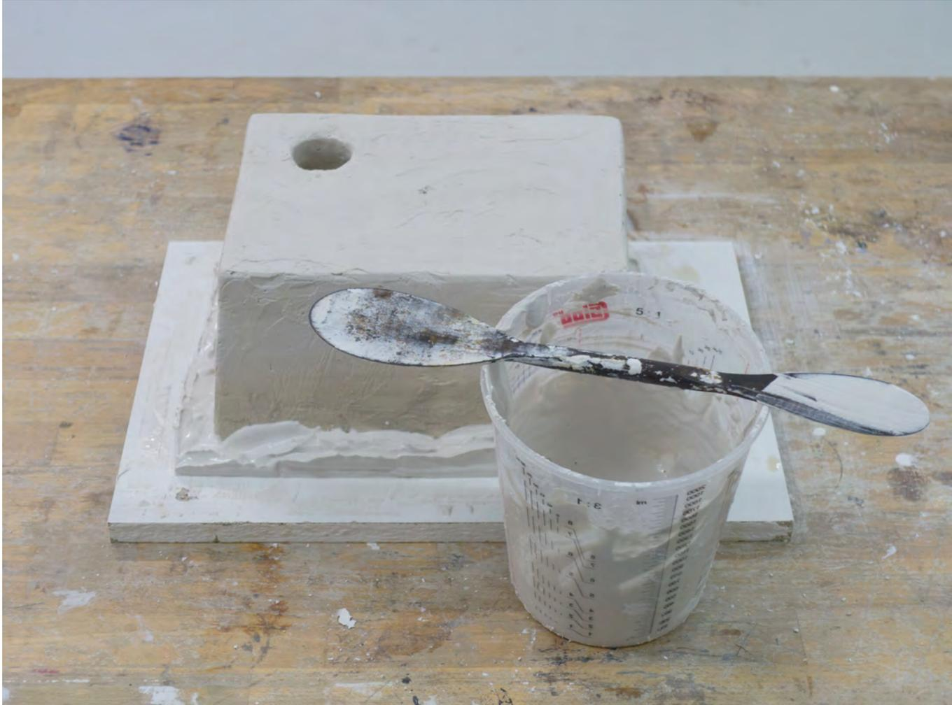
Auf der Arbeitsplatte wird um die justierte Stützform herum eine kleine Mauer aus Gips gebaut. Diese Mauer unterbindet, dass durch eventuell vorhandene Löcher zwischen Arbeitsplatte und Stützform Silikon nach außen gelangt.
