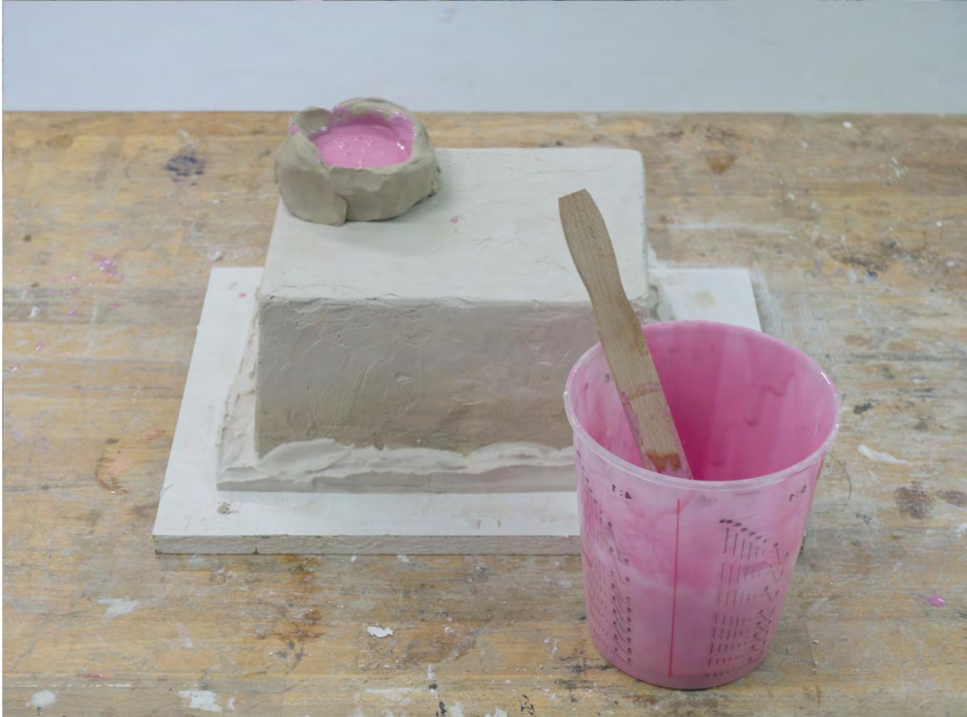
Wenn alles geklappt hat, quillt das Silikon durch die Füllöffnung und den gebohrten Entlüftungsschacht.
