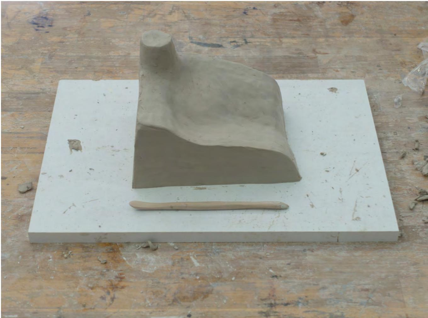
Die Füllöffnung wird mit dem zuvor aufgebrauchten Distanzmaterial verbunden.
