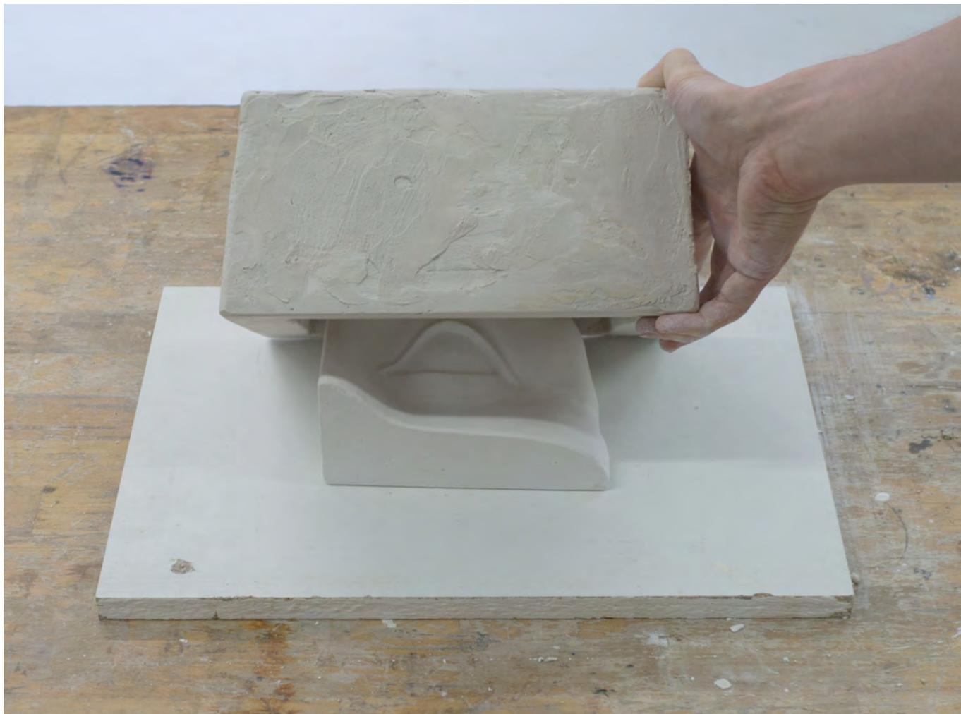
Auf die Arbeitsplatte legen wir zuallererst die Plastik mit der flächigen Seite nach unten. Die gereinigte Stützform wird über die Plastik gestülpt. Die Stützform wird so justiert, dass um die Plastik herum ein gleichmäßiger Freiraum besteht.
