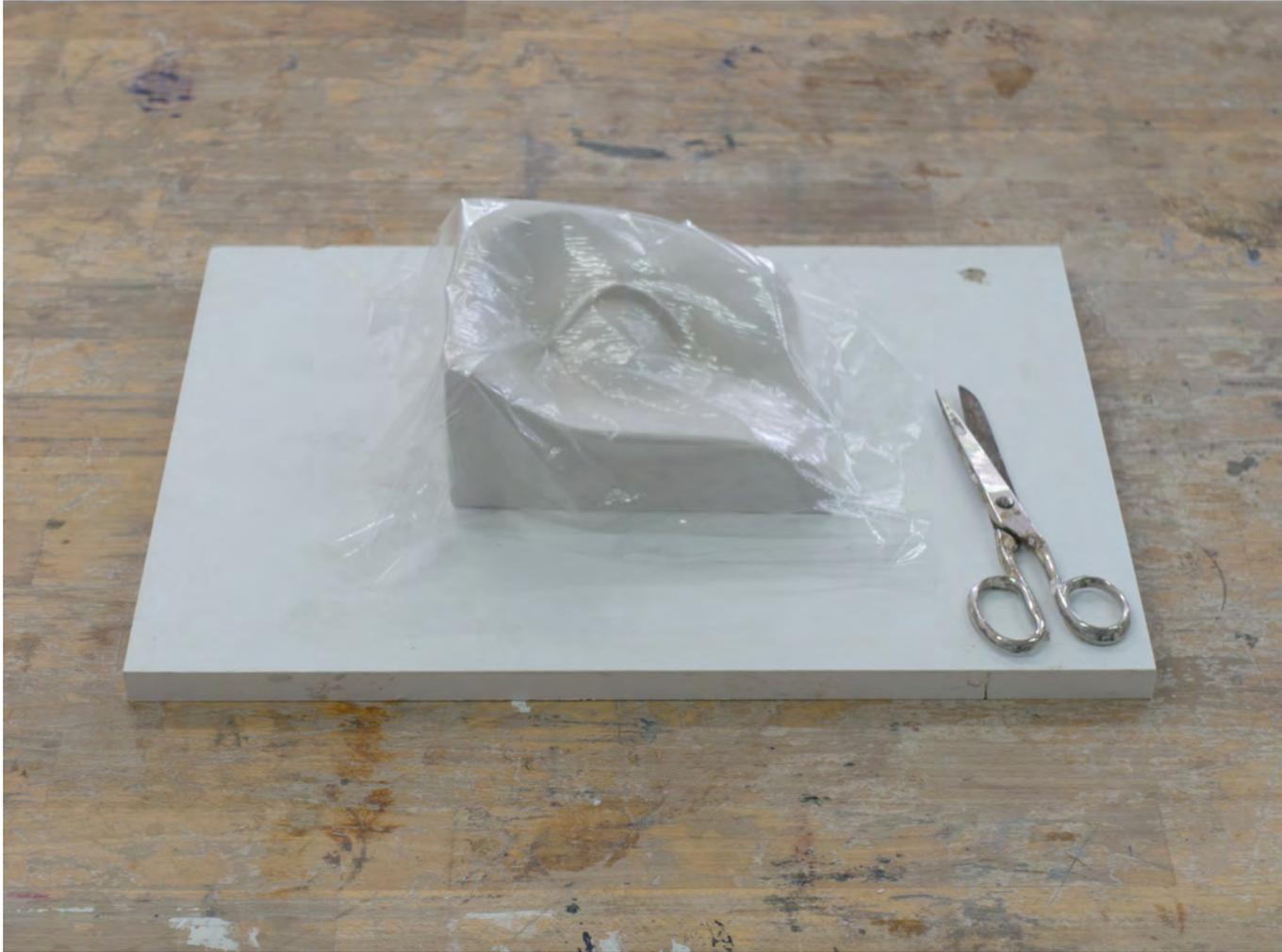
Die Plastik soll während der Herstellung der Mantelform keinen Schaden nehmen oder schmutzig werden. Aus diesem Grund bedecken wir die Plastik mit einer dünnen Folie.
