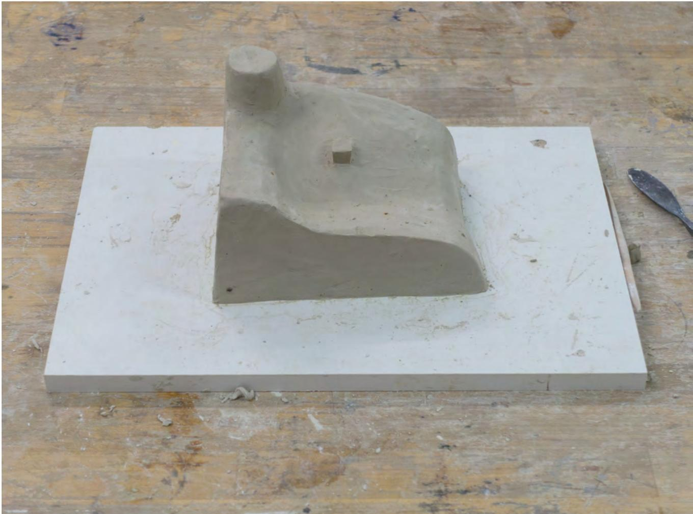
In unserem Beispiel benötigen wir eigentlich keine Ankerprofile. Denn der Mantel ist dick, das Silikon relativ hart. Wir werden dennoch ein Ankerprofil in der Mitte der Mantelform platzieren. So wird später der Mantel fest an die Stützform gedrückt.
