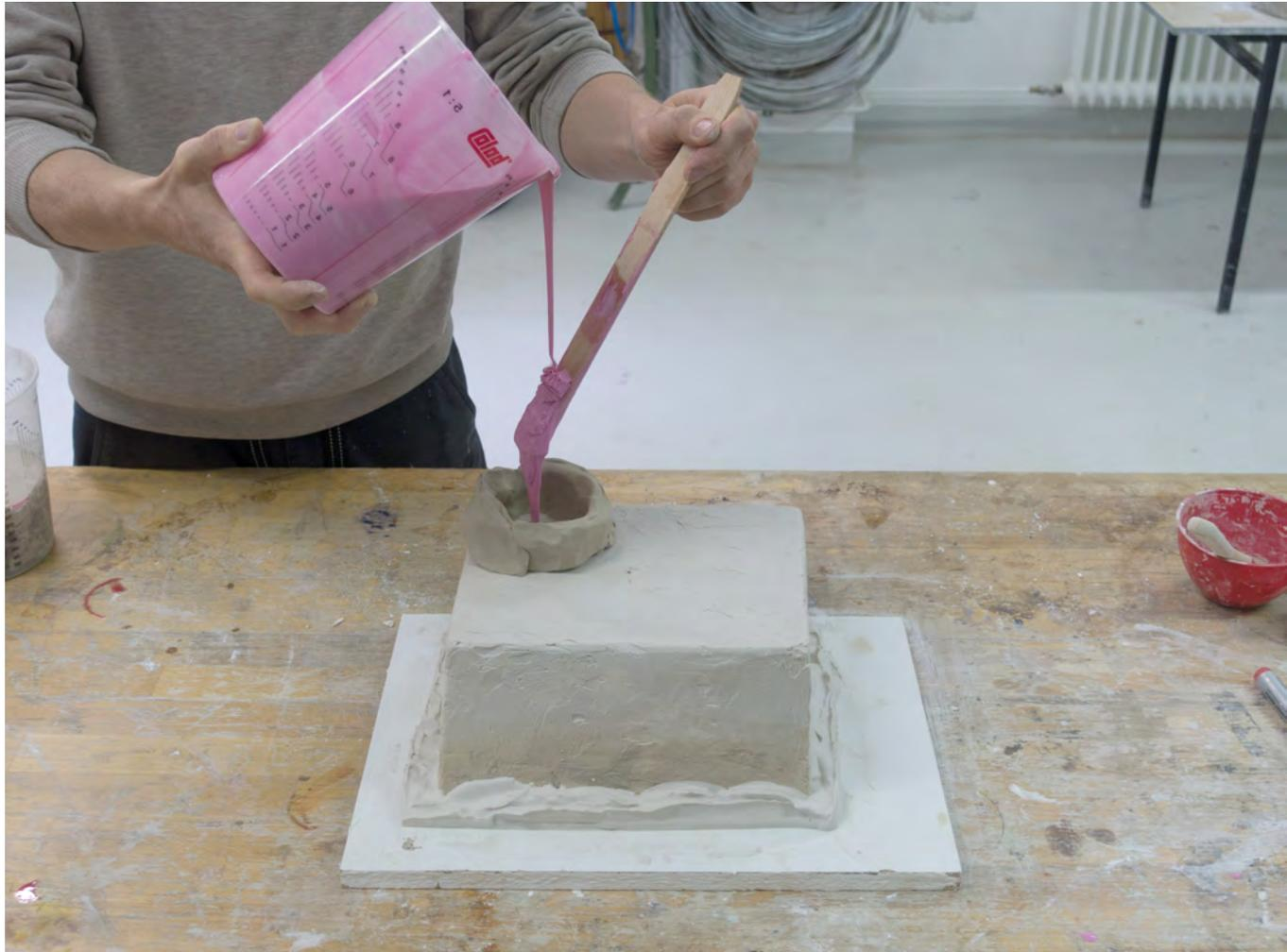
Mit einer Tonmauer, die wir um die Füllöffnung herum aufbauen, erweitern wir den Gießbereich und verhindern, dass unnötig Silikon durch Verschütten verbraucht wird.
