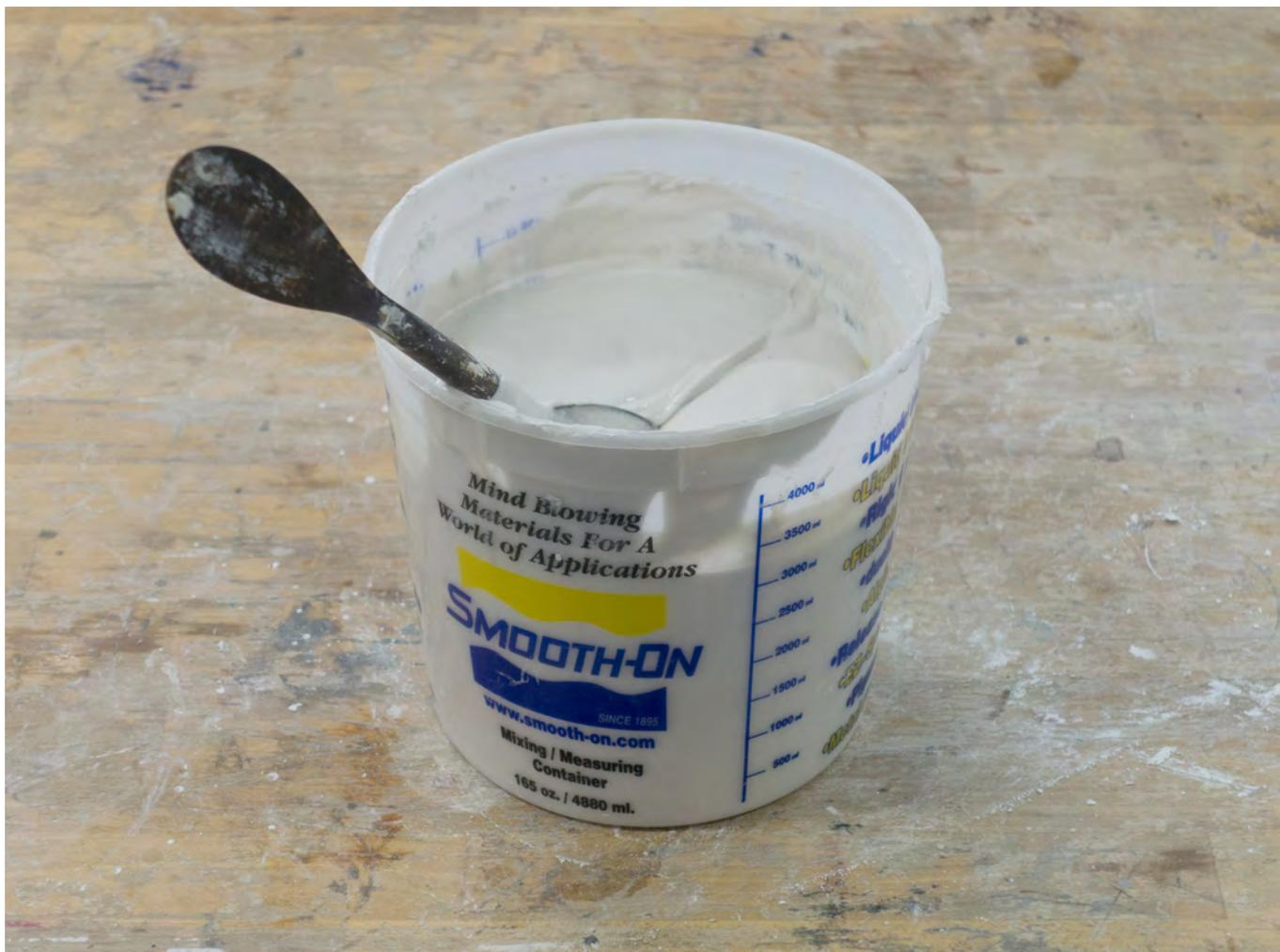
Um zu testen, ob der Gips spachtelbar ist, schneiden wir von Zeit zu Zeit eine Furche mit Hilfe des Spachtels durch die Gipsmasse. Wenn die Furche bleibt, ist der Gips spachtelbar, und wir beginnen mit dem Bau der Stützform.
